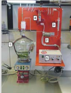
(1) Probengefäß, (2) Heizblock, (3) Filterhalter, (4) Miniaturpumpe, (5) Steuergerät
